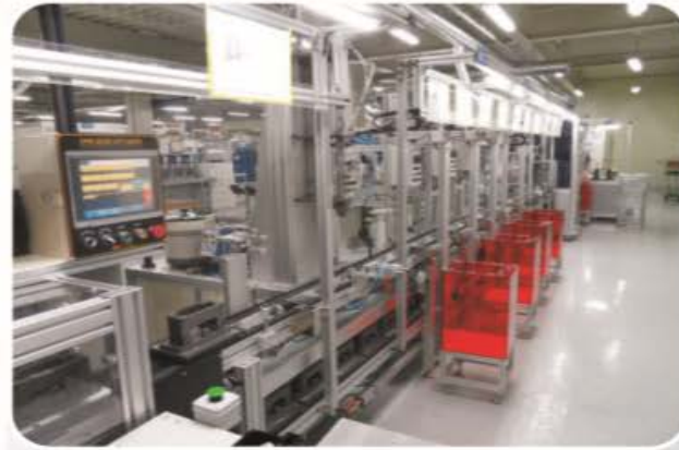
EPB 자동조립 Line (자동차 부품)
